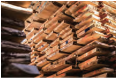
板材の乾燥 木材に含まれる水分量を調整して安定性を高める。
