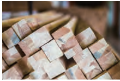
板材の断裁、フィンガージョイント、ラミネート加工 目の異なる部位を組み合わせることで集成材に加工することで反りや曲がりを防ぐ。
