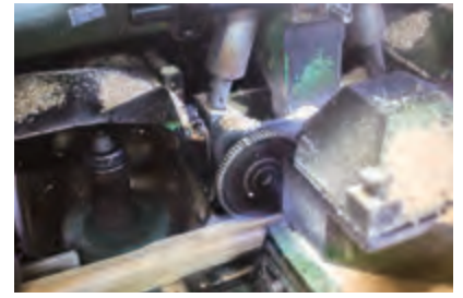
削り出し モルダーと呼ばれる機械でデザインに応じた形状に削る。
