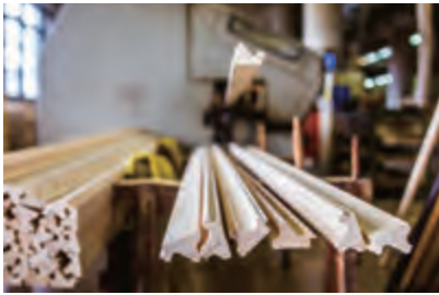
やすりがけ 削り出したモールディングの表面を滑らかに磨く。
